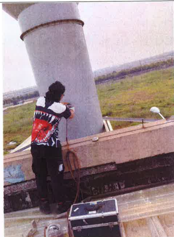
有组织废气采样采样
